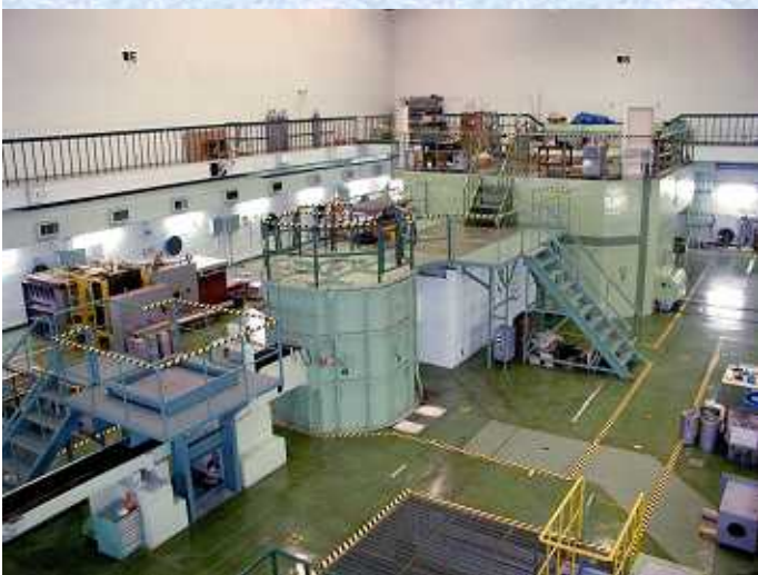
中性子照射下材料トリチウム相互作用 研究に用いる東大「弥生」炉
